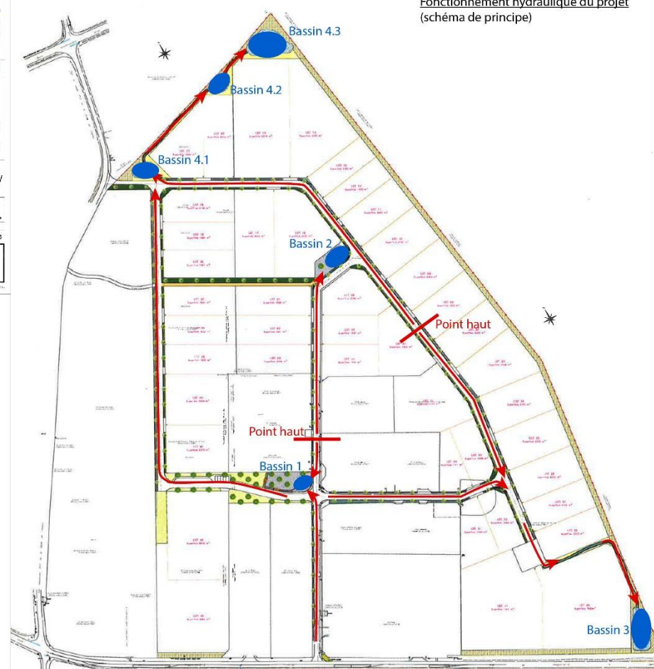
^ Détail des bassins de gestion des eaux pluviales (Réalisation Expertise Urbaine)
